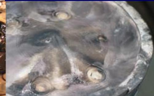
Ascheablagerungen - Kolben
